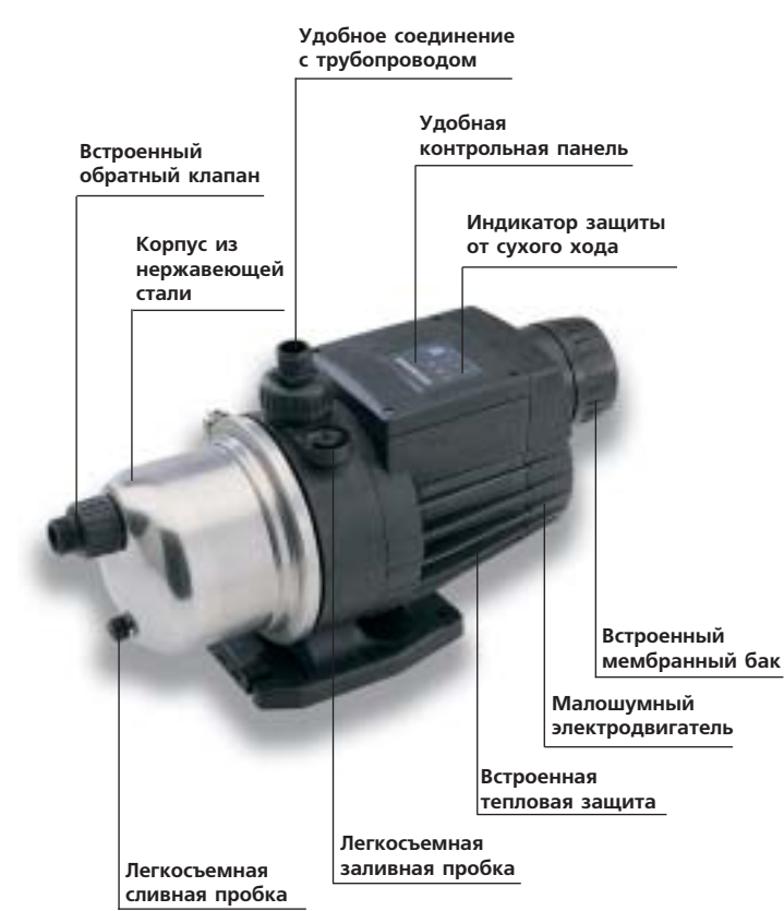
Поддача до 4 м 3 /ч Напор до 44 м Потребляемая мощность до 0,67 кВт Температура перекачиваемой среды до 35°C Высота самовсасывания до 8 м
